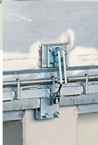
Zabezpieczenie przed opadnięciem
