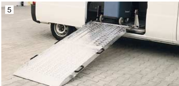
5 Rampa montowana w drzwiach bocznych
