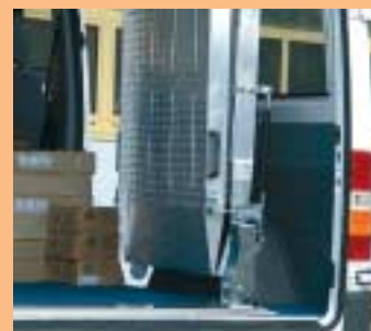
Rampa jest obracalna zarówno na zewnątrz jak też do wnętrza pojazdu.
