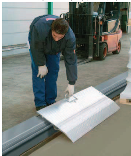
Nakładkę położyć na podłogę wagonu wprowadzając profil łączący w szynę.
